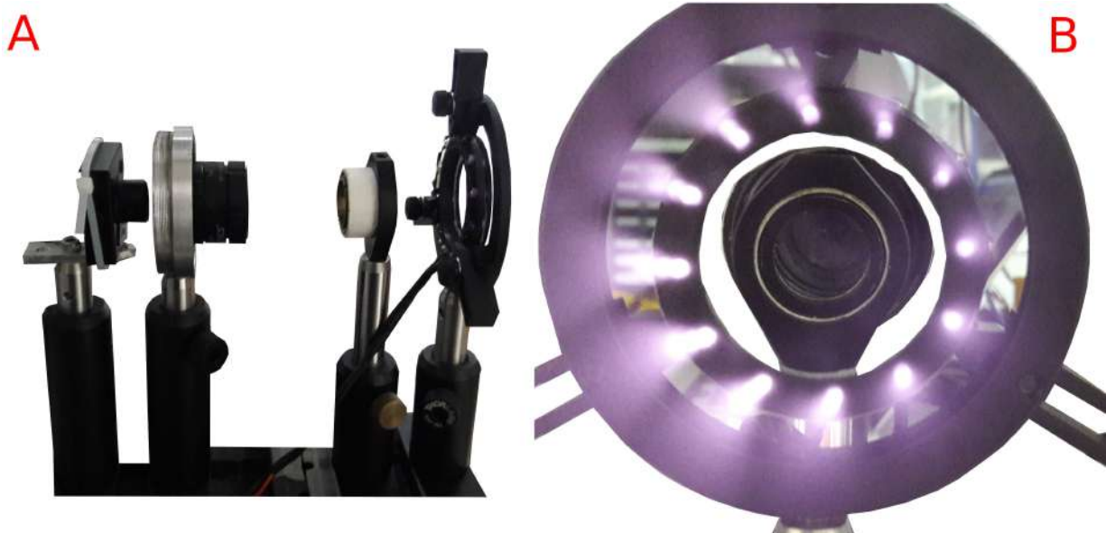
Figura 6: Sistema telescópico invertido. A imagem A apresenta a vista lateral desse sistema enquanto B , a frontal. Fonte: Elaborada pelo autor.
