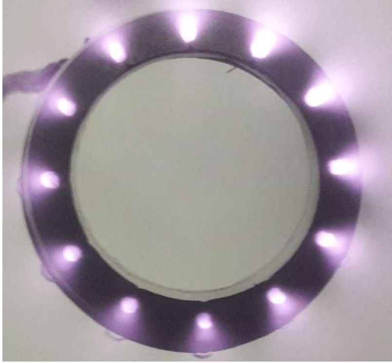
Figura 5: Anel de LEDs utilizado na iluminação. Pode-se notar feixes de luz saindo de cada um dos orifícios onde se encontram os LEDs, visíveis somente por meio de uma câmera que opere na região do infra vermelho. Fonte: Elaborada pelo autor.
